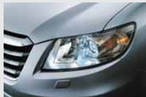
Przednie reflektory ksenonowe ze spryskiwaczami
