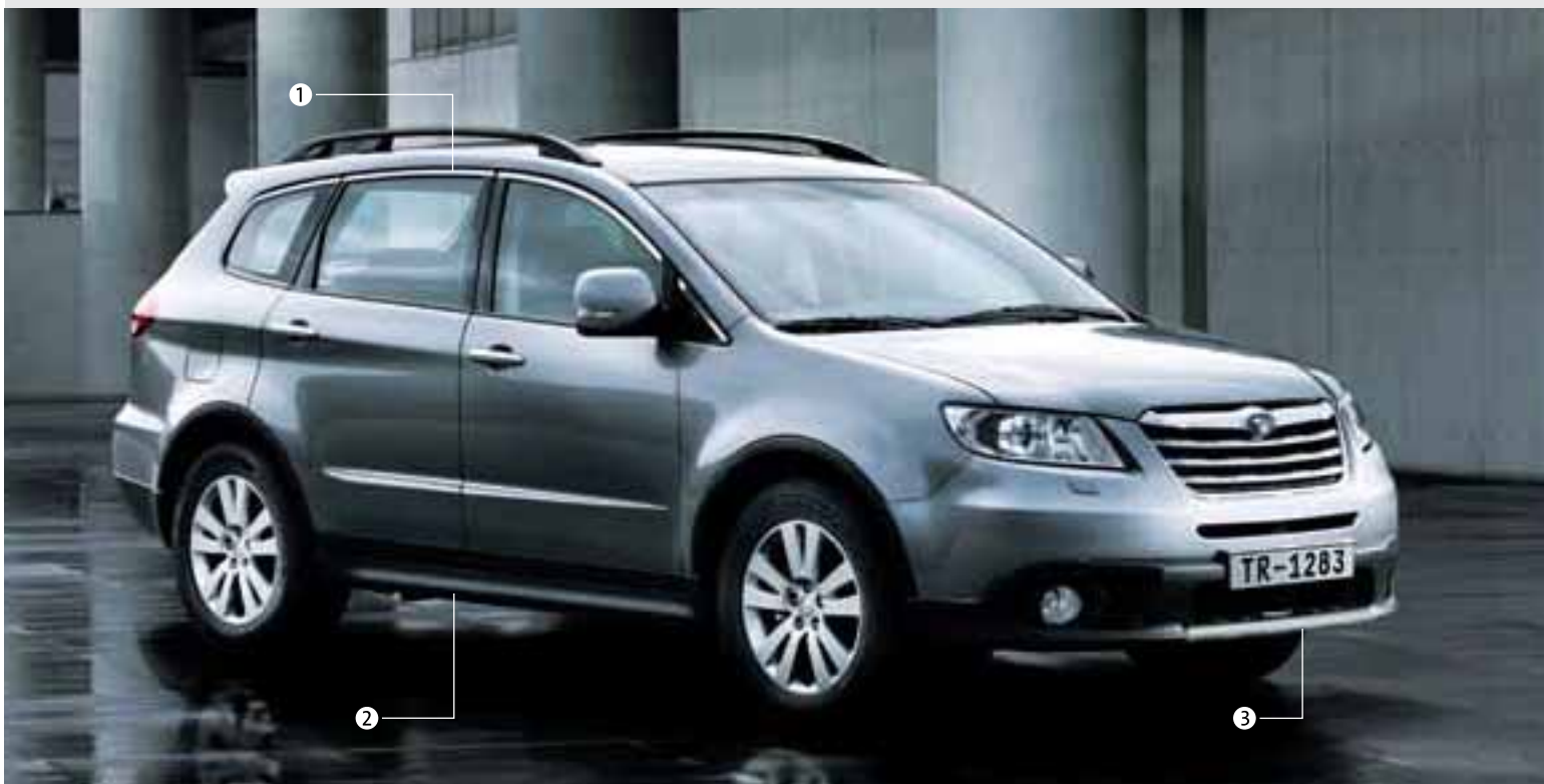
1: Owiewki boczne, 2: Listwy boczne, 3: Ochrona dolnej krawędzi zderzaka
