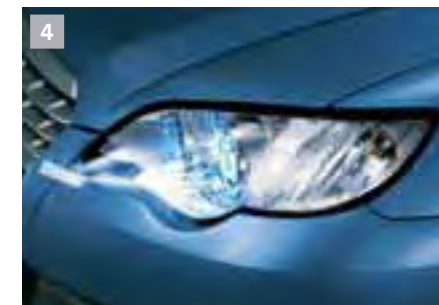
4 Przednie reflektory ksenonowe ze spryskiwaczami*1
