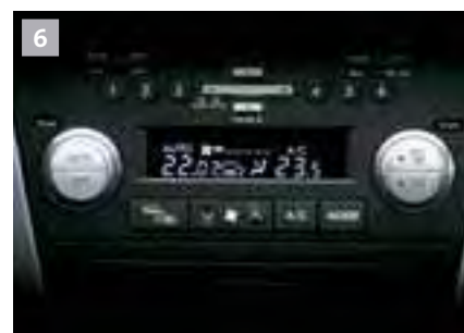
Automatyczna klimatyzacja dwustrefowa z filtrem przeciwpyłkowym
