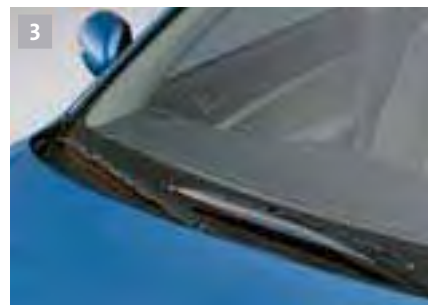
3 Podgrzewana szyba przednia w miejscu spoczynku piór wycieraczek
