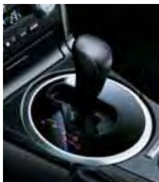
Elektronicznie sterowana, 5-cio biegowa skrzynia automatyczna SPORTSHIFT*1 (E-5AT)
